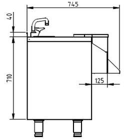
Conexión mojacapas: Tubo 8mm diam o Manguito Flexible 1/2"
