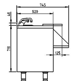
Conexión mojacapas: Tubo 8mm diam o Manguito Flexible 1/2"
