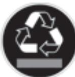
Esta u otra etiqueta similar se puede encontrar en la parte posterior del electrodoméstico. Indica que hay paneles de aislamiento al vacío (VIP) o paneles de perlita en la puerta y/o en la carcasa. Esta advertencia solo es relevante para el reciclaje. No retire la etiqueta.
