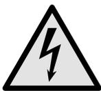
El símbolo se encuentra en la parte posterior del electrodoméstico en el área del relé de alarma e indica el siguiente peligro: **¡Descarga eléctrica!** Incluso si el electrodoméstico está desconectado de la red eléctrica, aún puede haber voltaje externo. No quite las etiquetas.
